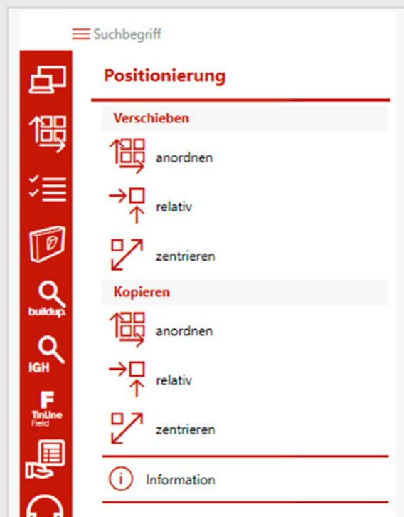
Nutzen Sie die Positionierungsfunktionen, um Bauteile in einem Raum angeordnet oder an den Kabeltrassen ausgerichtet zu positionieren. Nachträgliche Änderungen im Projekt sind nicht mehr zeitintensiv, da Ihre Bauteile jederzeit neu ausgerichtet werden können.
