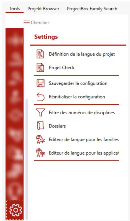
Si les GUIDS des familles sont incorrects ou manquants, vous ne pouvez pas les déposer. Pour éviter cela, nous avons créé le nouvel outil Message d'erreur GUID (CheckProjet). Le nouvel outil «CheckProjet» se trouve dans la boîte à outils TinLine sous «Paramètres».
