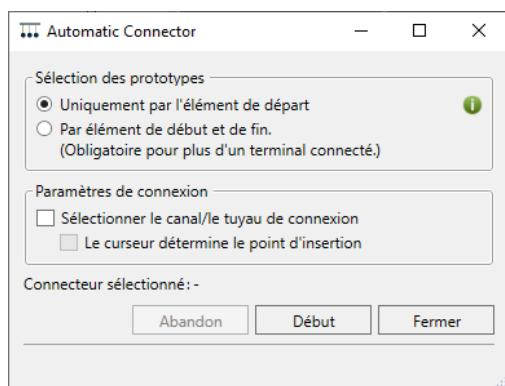
Grâce à cette fonction, vous pouvez faire en sorte que toutes les autres sorties de ventilation soient connectées de manière identique avec tous les composants sur la base d'un prototype (par exemple, une sortie de ventilation connectée au conduit de ventilation avec un tuyau flexible et un régulateur de débit volumétrique).
